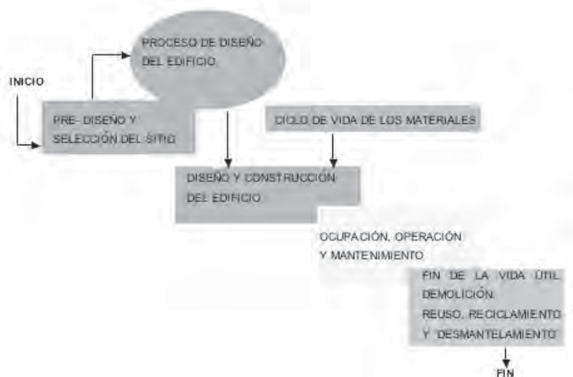
Figura 1. Ciclo de vida de los edificios y su relación con el proceso de diseño del edificio (Fuente: elaboración propia, Silverio Hernández Moreno, 2002).
