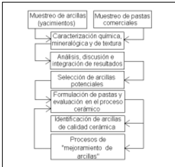
Figura 1. Diagrama de flujo con las etapas para la identificación y selección de arcillas regionales de calidad cerámica.
