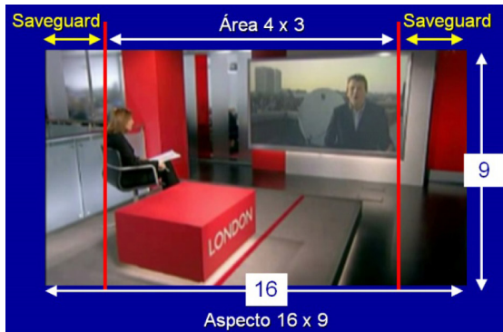
Figura 8: Saveguard da área 4:3 em captação 16:9 Cena do telejornal BBC News–BBC Londres Esquema produzido pelo autor
