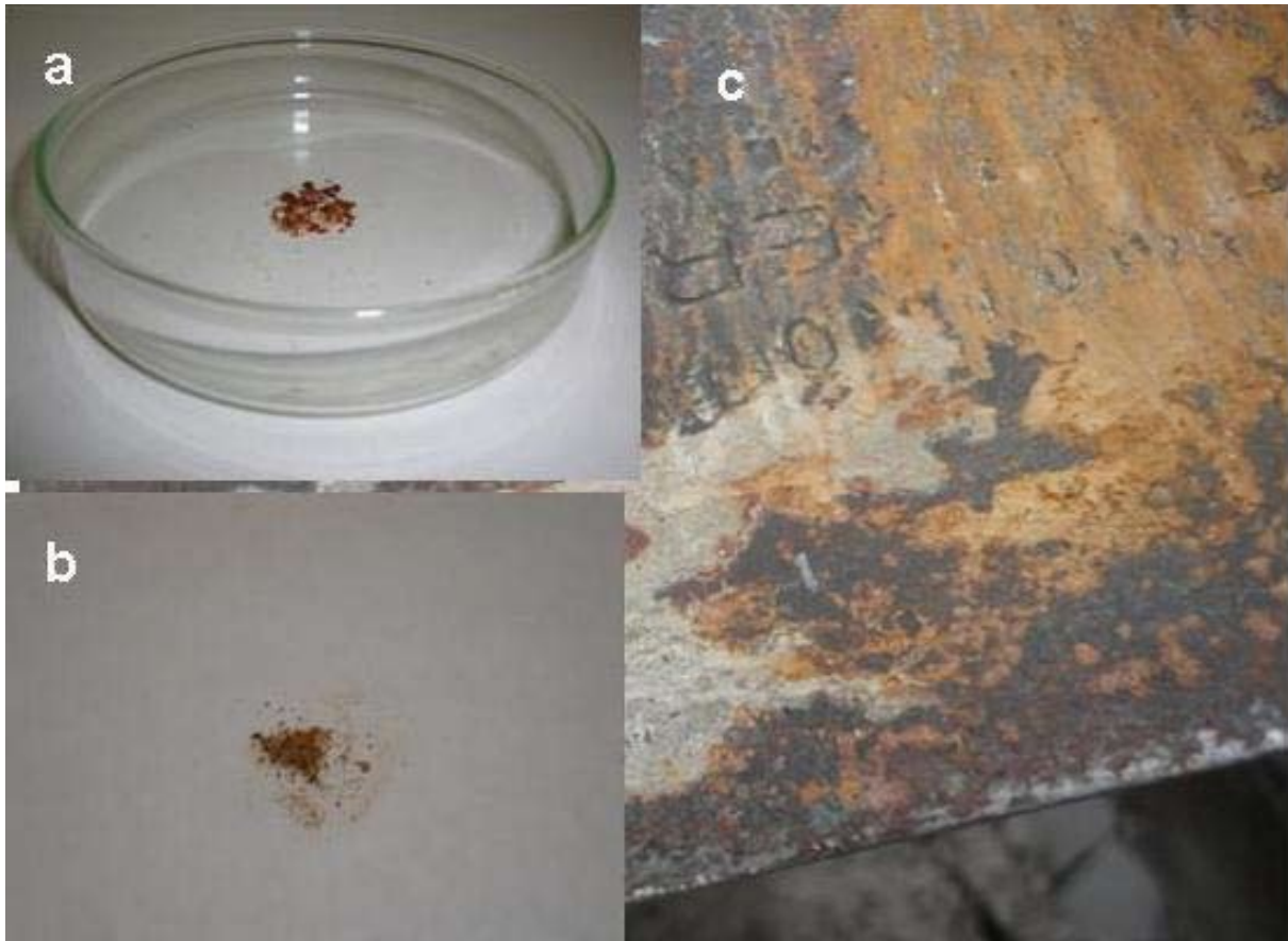
Figura 7. Efectos de alteración hidrolítica: a) material oxidado por tratamiento en el laboratorio, b) y c) material oxidado por alteración en condiciones naturales.
