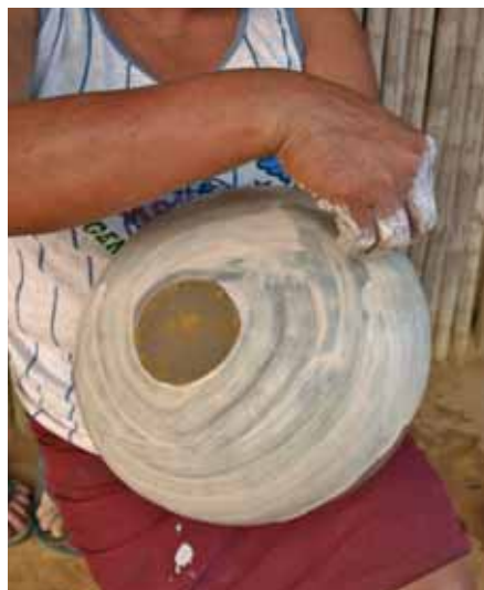
△Engobando un tiesto o plato con tierra blanca.
