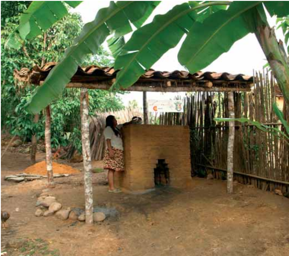
△Nuevo horno que facilita la quema de numerosas piezas a la vez y en cualquier época del año. Tiene la ventaja de consumir menos leña y de utilizar residuos de madera y otros productos o materiales naturales. Proyecto de Cooperación para el Desarrollo Asociación Exterior XXI - AECID.
