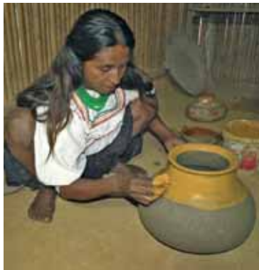
▷ Engobado del cuello (kunka) de un tinajón chichero.
