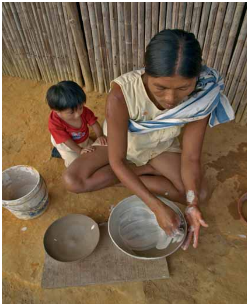
△Engobando un tiesto o plato con tierra blanca.
