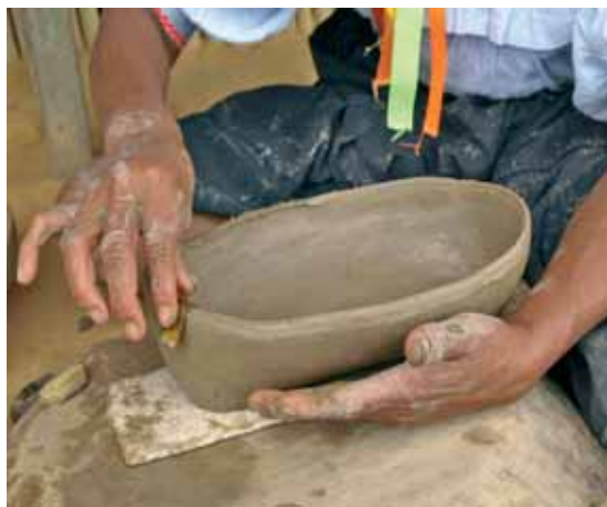
△Alisado fino con llunchina (trozo de cáscara de plátano).
