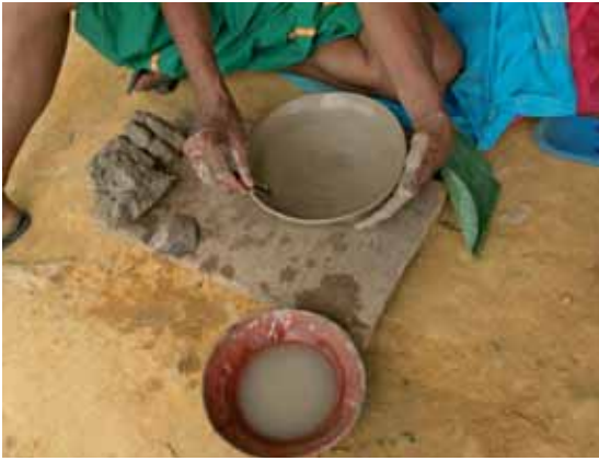
△Acabado fino del borde del tiesto o plato pequeño con la llunchina.
