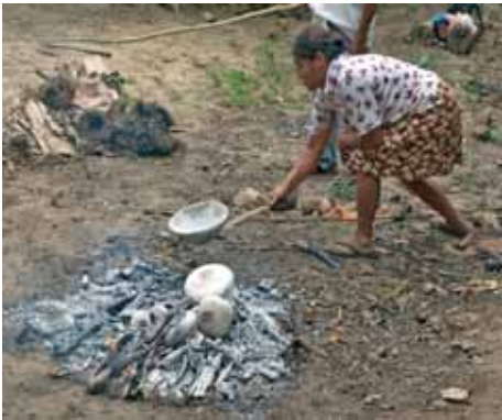
△Retirada de las piezas con la ayuda de una vara kaspi.
