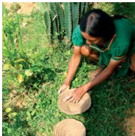
△Endurado (secado al sol) de los tiestos o platos.
