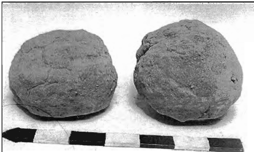
Fig. 5. Modelos de adobito de esta pared de Baños de Boza
