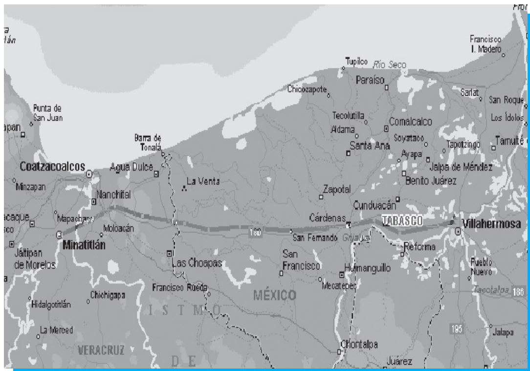
Fig. 4. Trazo del D.D.V. para el poliducto de 12" de diámetro nominal (Minatitlán-Villahermosa) y especificación API-STD-5L, Grado X-52, estado de Tabasco.
