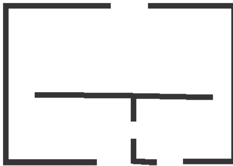
FIGURA 3 Convención gráfica para la aparición de pasos y accesos alternativos en una estructura de acuerdo con el análisis de sintaxis espacial.
