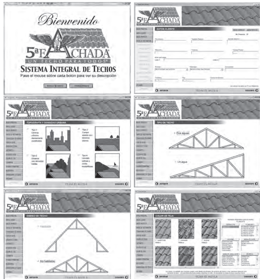
Figura 2. Algunas pantallas de la interfase de usuario para la introducción de datos en el sistema de cálculo de "Quinta Fachada". En el orden de arriba-abajo, derecha-izquierda: a) presentación del programa, b) datos del comprador, c) topografía y densidad urbana, d) número de aguas, e) tipo de estructura y f) tipos de tejas.
