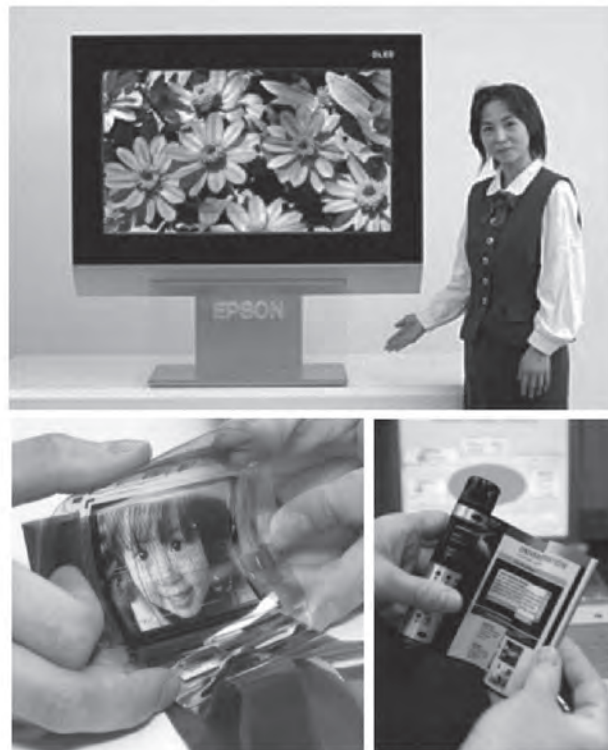
Figura 1. Pantallas ( displays ) delgadas, flexibles, de bajo consumo energético y con gran nitidez de imágenes basadas en la tecnología de OLEDs. Imágenes tomadas de [10].
