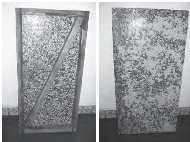
Figura 7. Superficie de contacto polietileno reciclado montado en la estructura convencional de una "tarima" de madera.
