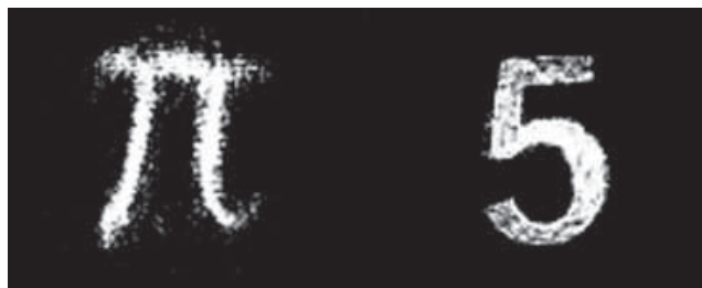
Figura 6. Imágenes bidimensionales dinámicas (reversibles) de los números "π" y "5" grabadas sobre un polímero fotorefractivo orgánico, tienen un tamaño real de aproximadamente 2 mm 2
