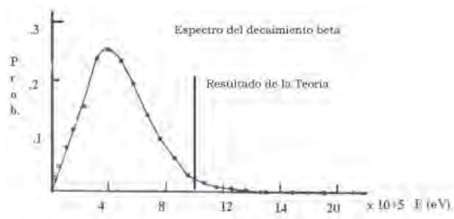
Figura 3. Espectro continuo de energía del electrón proveniente del decaimiento beta de un nucleón (Scott, 1935). Está en franca contradicción con el cálculo teórico ( 10.0 \times 10^5 eV), un solo valor, mostrado como una línea continua considerando la mecánica cuántica y la teoría de la relatividad especial. Sin tomar en cuenta otra partícula más que las conocidas y observadas, hay contradicción con el principio de conservación de la energía y el momento.
