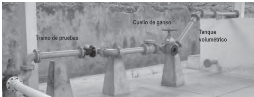
Figura 3. Vista general del tramo de pruebas, cuello de ganso y tanque volumétrico.
