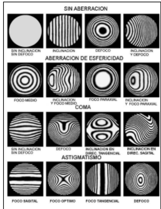
Figura 4. Interferogramas de las aberraciones primarias en un interferómetro de Twyman-Green.
