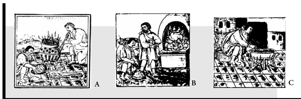
Figura 8. A. Enfriamiento del molde y fundición del metal. B. El molde se calienta para que se pierda el modelo de cera. C. Calentamiento del molde después de colado el oro.
