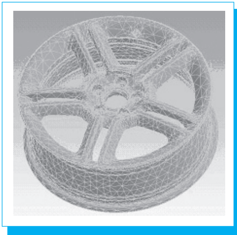
Fig. 8. Red de elementos finitos.
