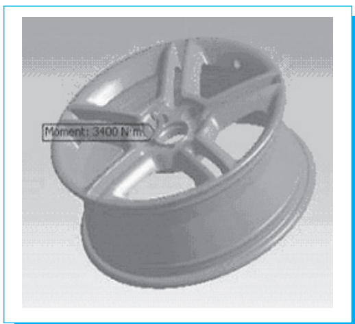
Fig. 9. Aplicación del momento flexionante sobre un solo brazo.
