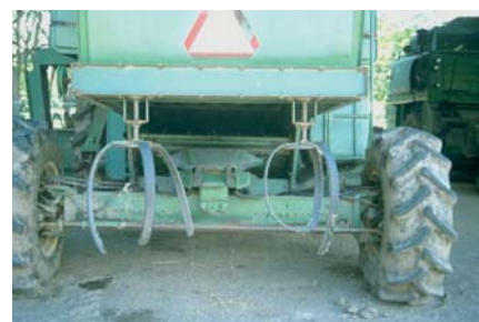
Lámina 57 Diseminador de paja construido por agricultor (T. Friedrich)
