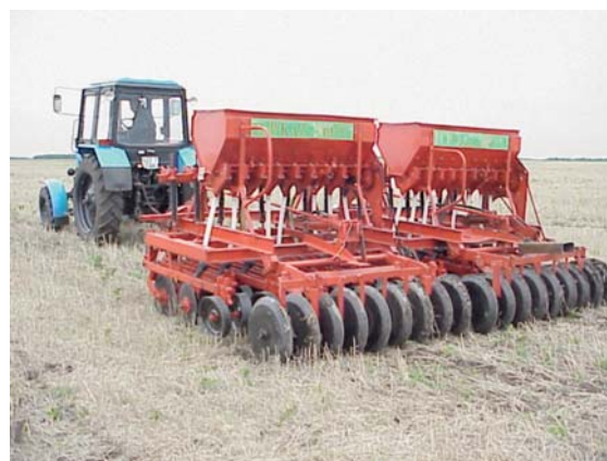
Lámina 103 La sembradora de chorrillo de arriba después de finalizada la modificación. La reconstrucción fue hecha por un agricultor usando los juegos de modificación. (T. Friedrich)
