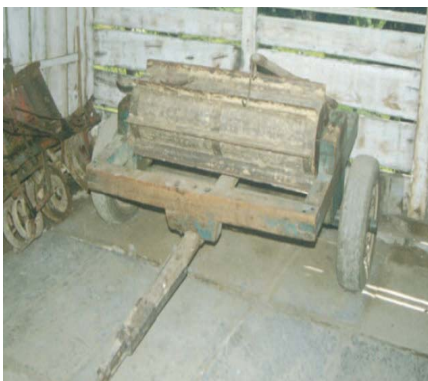
Lámina 47 Rodillo de cuchilla simple hecho de madera con barras de metal. (T. Friedrich)
