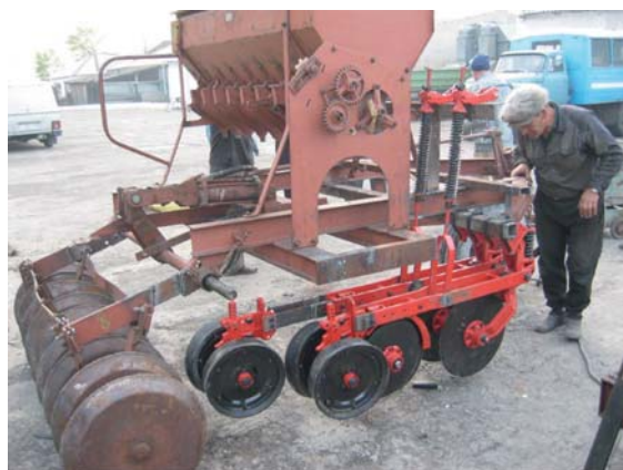
Lámina 102 Modificación de una sembradora a chorrillo convencional para su uso en no labranza: adicionando discos de corte nuevos y abridores de surco y modificando la estructura. (T. Friedrich)
