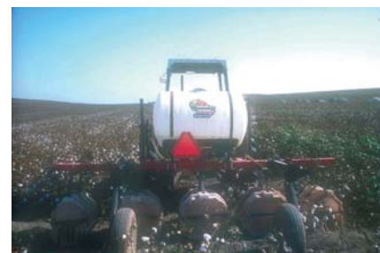
Lámina 63 Pulverizador de cultivo de hilera protegido para la aplicación de herbicidas entre las hileras del cultivo (T. Friedrich)
