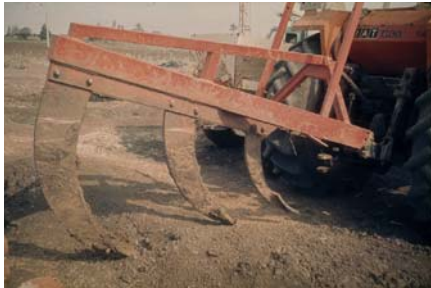
Lámina 17 Subsolador montado en tractor, usado para romper capas compactadas. T. Friedrich
