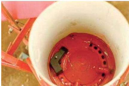
Lámina 77 Detalle del interior de una tolva de semillas con platos distribuidores de semillas. (V.H. de Freitas)
