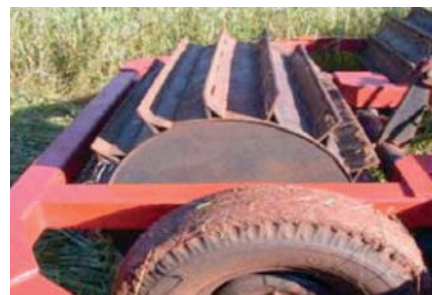
Lámina 49 El rodillo de cuchillas para aplastar y matar cultivos de cobertura, deja los residuos de la planta sobre la superficie del suelo. Es una herramienta esencial para el manejo del cultivo de cobertura. (R. Derpsch)
