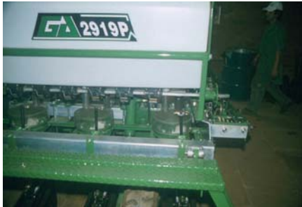
Lámina 99 Siembra chorrillo con plantadora de precisión: en la parte superior los rodillos alimentadores del sistema de medición para la siembra a chorrillo, debajo las cajas para los platos de semillas de la plantación de precisión. (T. Friedrich)
