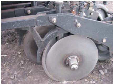
Lámina 87 Abridor de surco de doble disco, aquí con discos desalineados para mejorar la penetración. (T. Friedrich)
