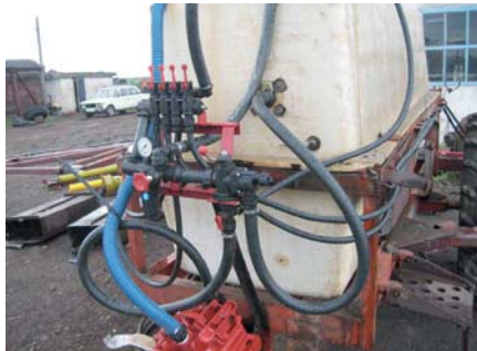
Lámina 65 Pulverizador Viejo mejorado con nueva bomba, controles y líneas de pulverización. (T. Friedrich)
