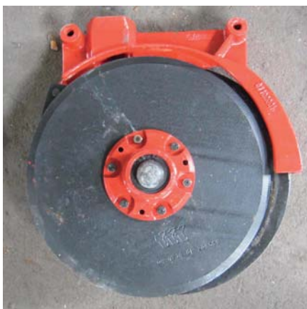
LÁMINA 88 Abridor de surco de doble disco con discos desalineados de diferentes diámetros (T. Friedrich)
