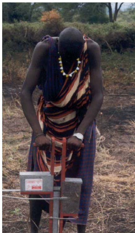
Lámina 68 Un Maasai en el Nordeste de Tanzania, evaluando la plantadora manual de punzada. (A.J. Bot)
