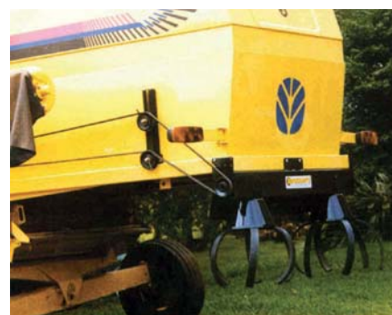
Lámina 56 Diseminador de paja en combinada (MAX - Irmãos Thonnigs Ltda.)
