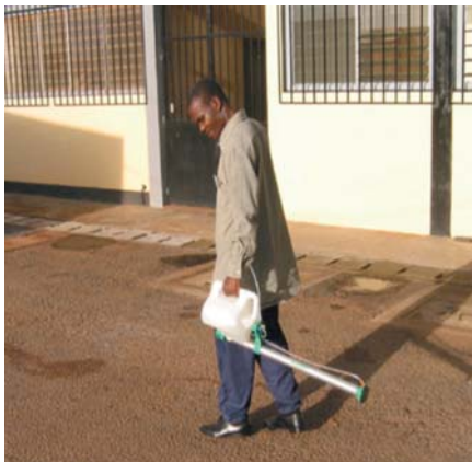
Lámina 60 El operador lleva la pulverizadora de bajo volumen de boquilla rotatoria para herbicidas. (T. Friedrich)
