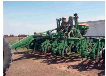
Lámina 97 Sembradora a chorrillos neumática de no labranza, con dos unidades centrales de medición y distribución (T. Friedrich)
