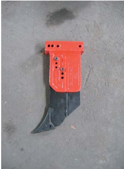
Lámina 91 Abridor de surco tipo cincel estrecho para pequeño movimiento del suelo (T. Friedrich)
