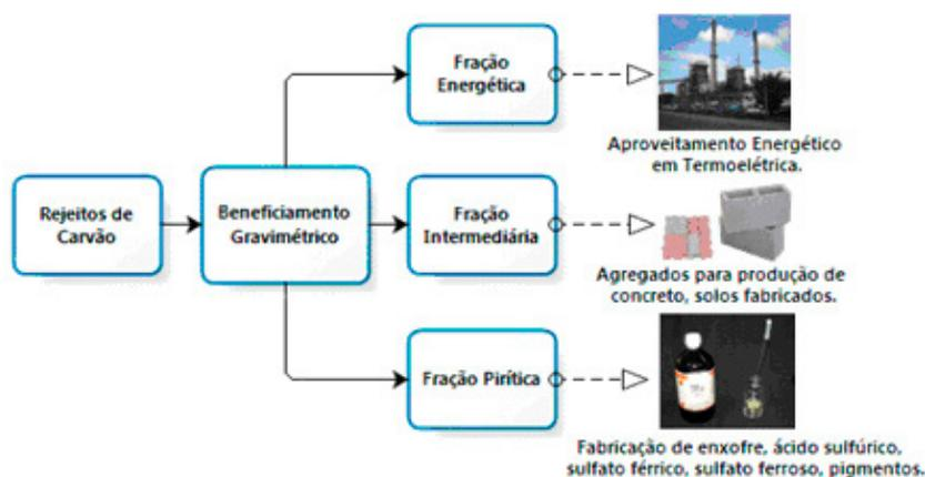
**Figura 3.** Esquema do processamento de rejeitos de acordo com a abordagem preventiva da geração de DAM proposto neste trabalho
