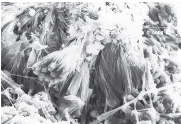
Figura 1: Micrografía por SEM a X6,000. Arcillas de tipo halloysitas. Piedra rosa del atrio de la Basílica Colegiata de Nuestra Señora de Guanajuato en Guanajuato, Gto., México.
